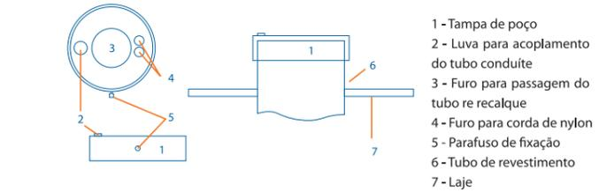
Aconselhamos instalar um conjunto de conexões na saída do poço a fim de possibilitar a regulagem da vazão da bomba, de acordo com a pré-estabelecida. A tubulação de recalque, até o reservatório ou ponto de descarga, deverá ser dimensionada para proporcionar as menores perdas de carga. Os desníveis superiores a 80m requerem a instalação de uma válvula de retenção de linha, a cada 65m, a partir da boca do poço.
