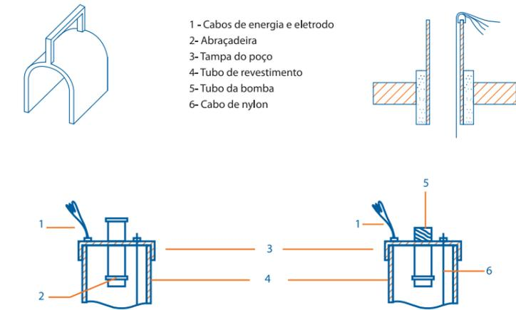
Após a descida de toda tubulação, deverão ser instalados os eletrodos para controle de nível.
