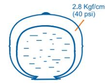
**3º Ciclo de Espera:** A pressão de desligamento da bomba foi atingida. O diafragma alcança sua posição limite superior, cheio de água, conforme sua capacidade.
