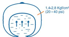
**2º Ciclo de Enchimento:** A água é bombeada para o diafragma, forçando-o dentro da câmara de ar e elevando sua pressão até 28 mca (40 PSI), quando o pressostato desligará a bomba.
