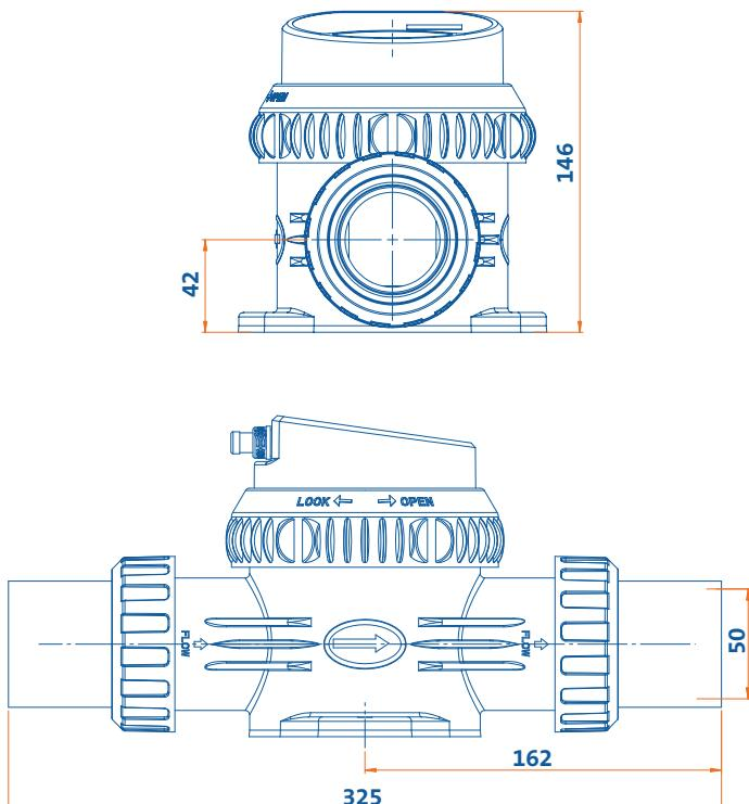
O Gerador de Cloro **SmartClor®** Dancor combina tecnologia inteligente com máxima eficiência. Opera com baixo teor de sal, regula automaticamente a concentração e oferece 4 níveis de produção. Conta com painel de LED, funções de auto-limpeza, autodiagnóstico e sistema de proteção contra sobrecarga, baixa vazão e alta temperatura.
